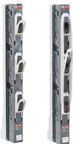
Трёхполюсный аппарат выполнен в двух вариантах - с одновременной коммутацией трех полюсов, либо с независимой коммутацией каждого полюса. Обеспечивает надежную коммутацию и защиту отходящих линий на токи до 160А, категория применения AC-23В. Предназначен для установки на систему шин с межфазным расстоянием 185мм. Габаритные размеры - 49x1169x662мм. По высоте соответствует аппаратам габаритов 1,2,3. Габарит предохранителя 00\*.
