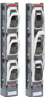
Наиболее востребованный ассортимент аппаратов на токи от 250 до 630А представлен в едином габарите 99x174x662мм. Аппараты предназначены для установки на систему шин с межфазным расстоянием 185мм. В комплекте поставляется удлиненная откидная кабельная крышка (+101мм к высоте) и комплект универсальных болтов М12. Конструкция аппаратов позволяет обеспечить быструю установку на систему шин ("U-образные" задние выводы). Габарит предохранителя 1, 2, 3\*.
