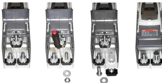
Выключатели ZLBM123 поставляются в стандартной комплектации с закладными болтами M12 для кабельных наконечников. Однако, если при монтаже кабеля болт M12 необходимо установить спереди, то гайку и болт можно легко поменять местами, как показано на рисунках.
